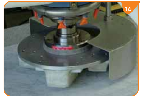
(ENG) Marble flat polishing (F) Polissage à plat de marbre (D) Marmorflächen schleifen (ESP) Pulido de marmol
