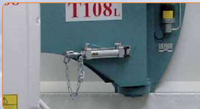
(ENG) Pneumatic cylinder for side pressure (D) Pneumatikzylinder für seitlichen Anpressdruck (F) Vérin pneumatique de pression latérale (ESP) Gato neumático de presión lateral
