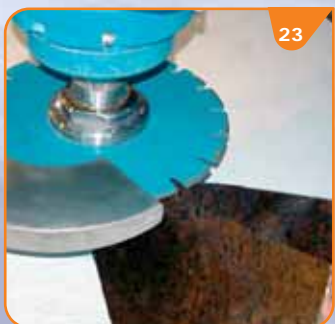
(ENG) Horizontal sawing (piece tilting) (F) Sciage horizontal (inclinaison de la pièce) (D) Horizontalsägen, auch bei Neigung des Werkstücks möglich (ESP) Corte horizontal (inclinación de la pieza)
