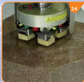
(ENG) Granite flat polishing (F) Polissage à plat granit (D) Granitschleifen mit B4-Kopf (ESP) Pulido de granito en superficies planas
