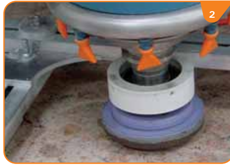
(ENG) Drainboard polishing (F) Polissage d'égouttoir (D) Polieren von Abtropfflächen (ESP) Pulido de rebajes
