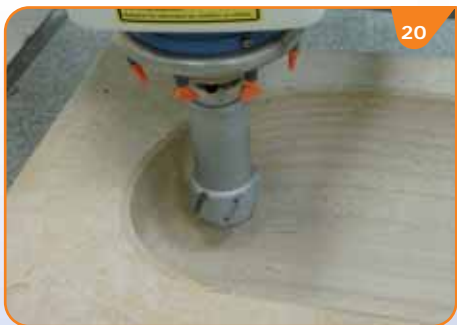
(ENG) Milling inside wash basin in limestone (F) Moulurage évier dans la masse en pierre calcaire (D) Fräsen eines Spülbeckens in Weichgestein (ESP) Fresado de fregadero macizo en piedra caliza
