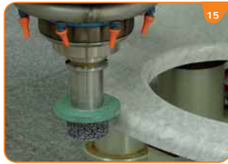
(ENG) Marble milling (F) Moulurage marbre (D) Polieren eines Viertelrundstabes aus Marmor (ESP) Moldurado de marmol
