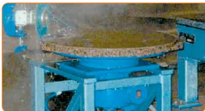
(ENG) Motorized turning plate, maxi diameter 1200 mm (D) Drehtisch mit Elektromoto (F) Plateau tournant motorisé (ESP) Plato giratorio motorizado diámetro máximo 1200 mm
