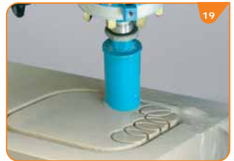
(ENG) Core drilling- stock removal (F) Percage évier dans la masse (D) Bohren eines Spülbeckens in Weichgestein (ESP) Taladro de fregadero macizo
