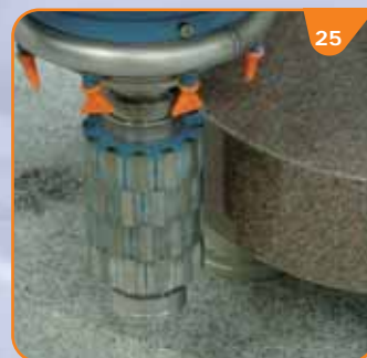
(ENG) Thick granite edge milling (F) Fraisage de chant épais courbes (D) Fräsen von Grabsteinkonturen (ESP) Fresado de canto grueso
