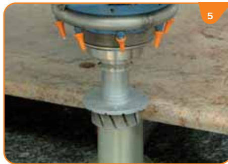
(ENG) 1/4 round milling (F) Moulurage 1/4 rond (D) Profilfräsen eines Viertelrundstabes (ESP) Moldurado cuarto redondo
